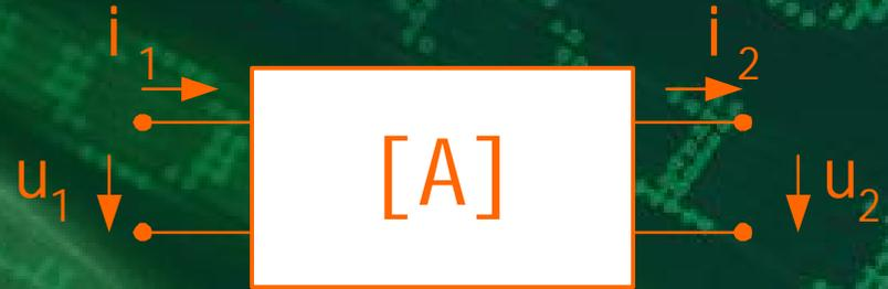
$$\begin{bmatrix} u_1 \\ i_1 \end{bmatrix} = \begin{bmatrix} A_{11} & A_{12} \\ A_{21} & A_{22} \end{bmatrix} \begin{bmatrix} u_2 \\ i_2 \end{bmatrix}$$
