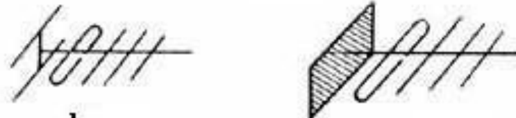
八木天线的反射器和引向器
