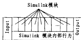
图 10 Simulink 模块封装成 UML 模型的结构图
