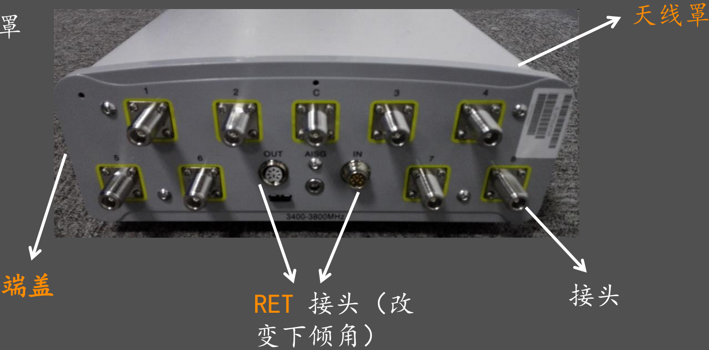
基站天线的外部组成部分
