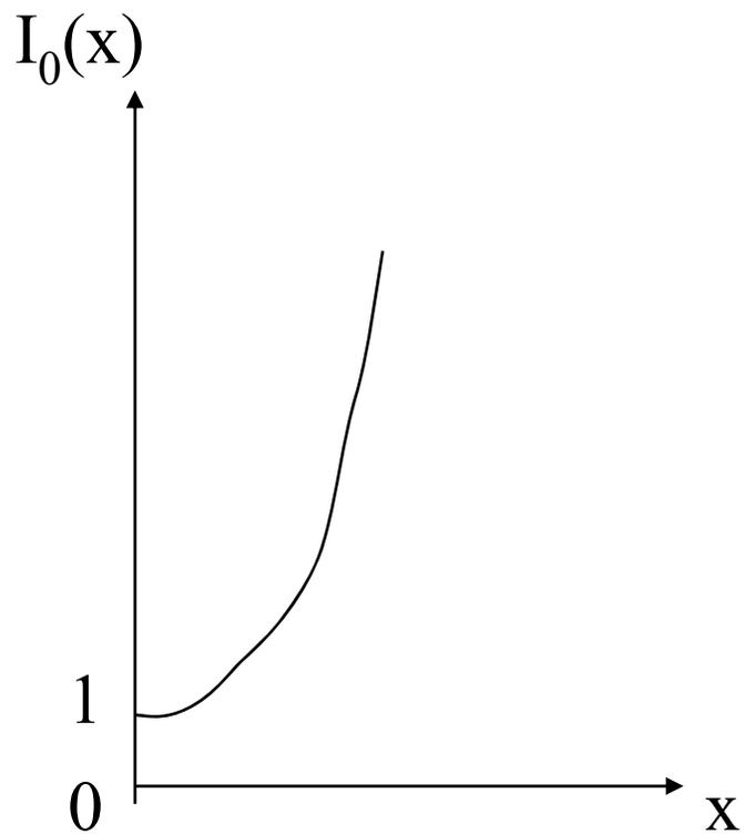
图1 零阶修正贝塞尔函数
