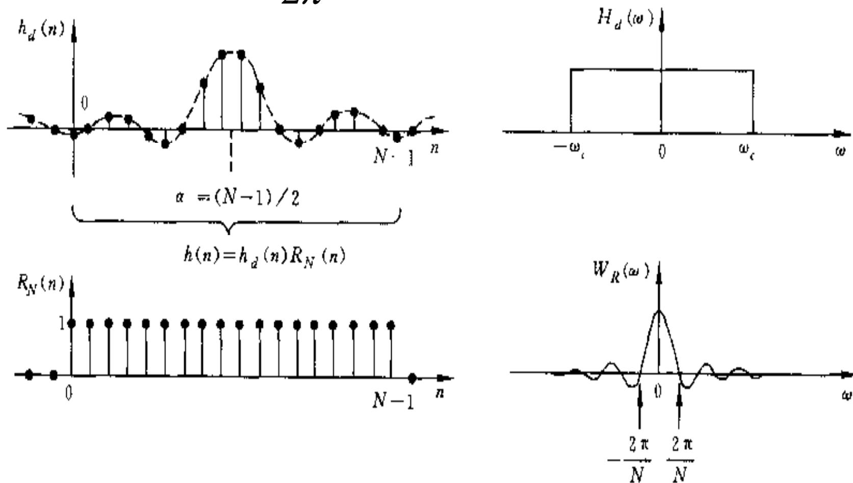
图 7-7 理想矩形幅频特性的  $h_d(n)$  和  $H_d(\omega)$  以及矩形窗函数序列的  $w(n) = R_N(n)$  及  $W_R(\omega)$
