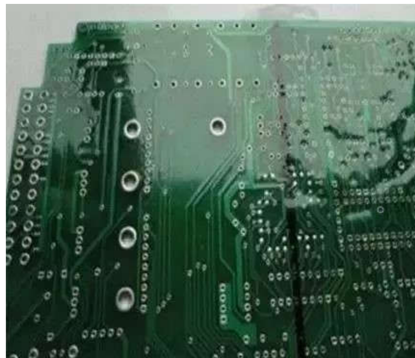
涂覆工艺后的 PCB 板
