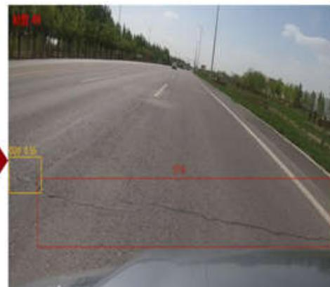
病害检测方法已经可以准确将图像中目标病害使用检测框标记并将对应的类别标签展示。但由于现实中拍摄病害存在尺寸较大、形状不规则、且同一处病害存在不连续等情况。若直接对检测框进行统计，必然会导致同一处病害的重复统计，造成病害统计结果没有参考价值。
