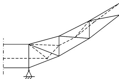
图 5 单片纵向筋优化前后结构对比
