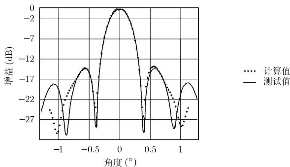
图3 天线变形后的远场方向图比较( $T_3$ )
