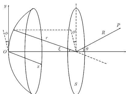
图 1 反射面天线变量示意图
