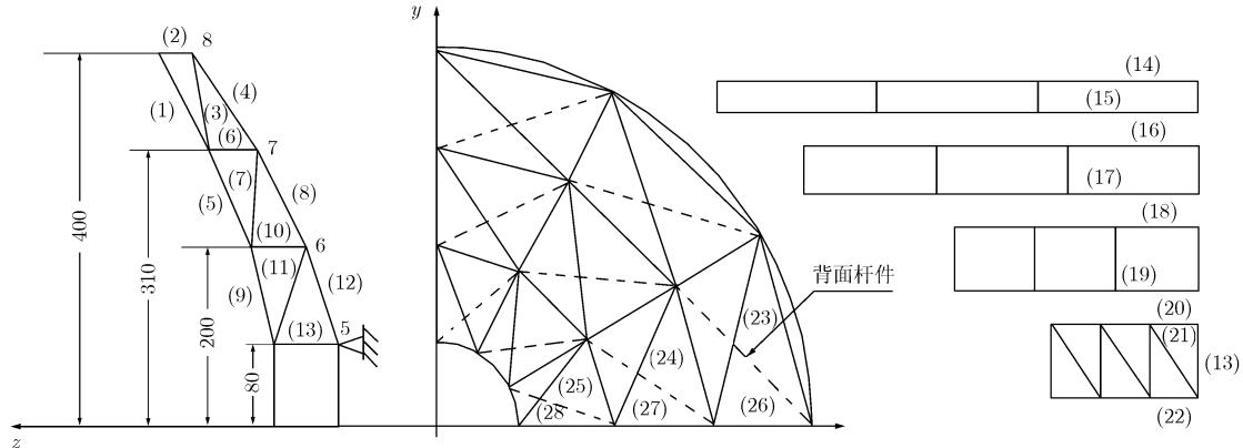
图 4 某 8 m 反射面天线骨架结构示意图(长度单位: cm)
